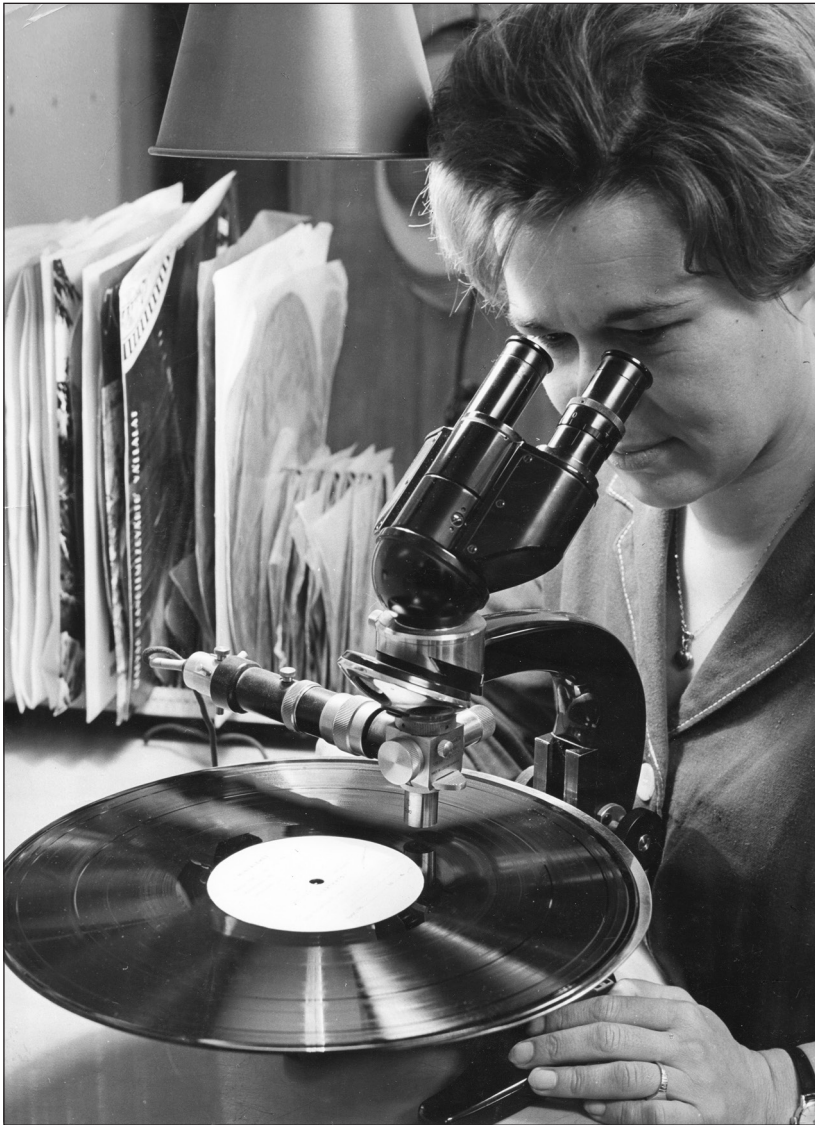
Bakelit hanglemez barázdáinak mikroszkópos vizsgálata 1970-ben. © Fortepan
